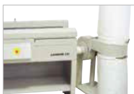
Système d'aspiration des déchets et vapeurs de colle
